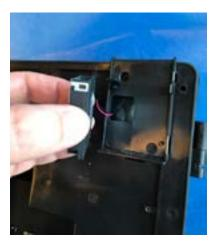
3. Cut fan wires at the fan
